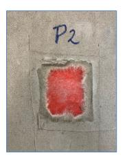
**Probeta 2:** Presenta resistencia superior a lo establecido en norma y su falla es de tipo  $6^{(*)}$ : Falla de cohesión de la membrana impermeabilizante.
