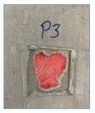
**Probeta 3:** Presenta resistencia superior a lo establecido en norma y su falla es de tipo  $6^{(*)}$ : Falla de cohesión de la membrana impermeabilizante
