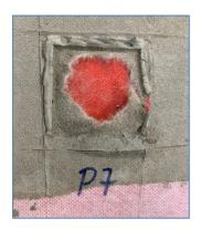
**Probeta 7:** Presenta resistencia superior a lo establecido en norma y su falla es de tipo **6**(\*): Falla de cohesión de la membrana impermeabilizante.
