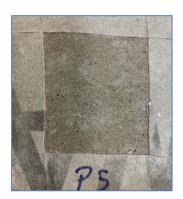
**Probeta 5:** Presenta resistencia superior a lo establecido en norma y su falla es de tipo 4: Falla de cohesión en el adhesivo.
