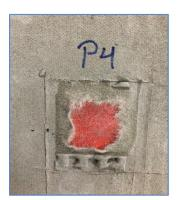
**Probeta 4:** Presenta resistencia superior a lo establecido en norma y su falla es de tipo **6**<sup>(\*)</sup>: Falla de cohesión de la membrana impermeabilizante.
