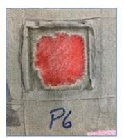
**Probeta 6:** Presenta resistencia superior a lo establecido en norma y su falla es de tipo **6**(\*): Falla de cohesión de la membrana impermeabilizante.
