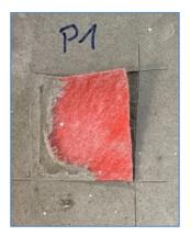
**Probeta 1:** Presenta resistencia superior a lo establecido en norma y su falla es de tipo  $6^{(*)}$ : Falla de cohesión de la membrana impermeabilizante.
