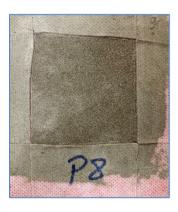
**Probeta 8:** Presenta resistencia superior a lo establecido en norma y su falla es de tipo 4: Falla de cohesión en el adhesivo.
