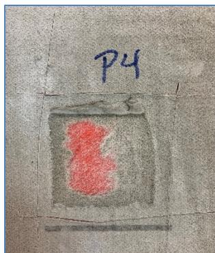
**Probeta 4:** Presenta resistencia superior a lo establecido en norma y su falla es de tipo **6<sup>(\*)</sup>**: Falla de cohesión de la membrana impermeabilizante.
